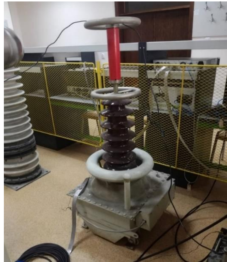
Fig. 1 – Transformatorul de încercare al sursei WPT 4,4/100
